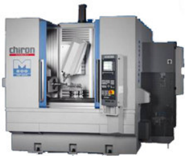
Chiron Mill 800 five axis HSC/HFC-Bearbeitung 5-achsig, Spindel 20'000 U/Min. bei 58 kW, X 800 mm, Y 630 mm, Z 550 mm
